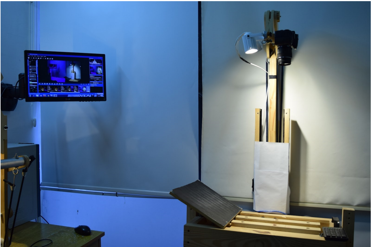
Figura 10. Modelo de escáner con cámara cenital armado especialmente para la digitalización del Libro Copiador del Museo de Física. Se utilizó a modo de atril, para sostener la otra sección del libro sin ejercer mucho peso de ninguno de los lados y tener espacio para girar las páginas sin doblarlas. Fuente: elaboración propia.
