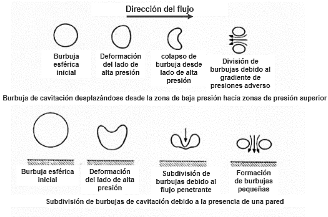
Figura 11.5-Mecanismos de formación de la cavitación.
