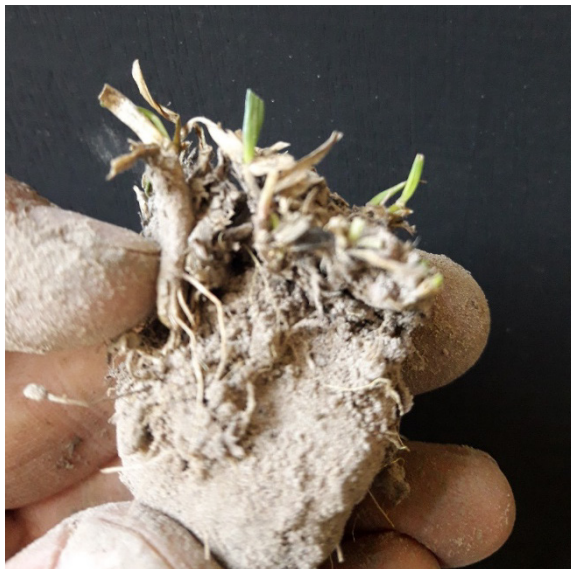
Figura 11. Muestra de micrositio de suelo, cilindro de 7 cm de profundidad x 2 cm de diámetro con los que se completó la muestra compuesta de suelo hasta obtener 1 kg de suelo (aproximadamente 30 cilindros).
