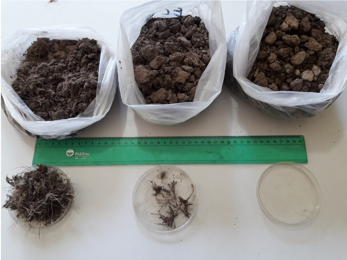
Figura 12. Muestras compuestas de suelo resultantes de la suma de extracciones de pequeños cilindros (7 cm de profundidad x 2 cm de diámetro) hasta completar aproximadamente 1 kilogramo de suelo y extracción de restos vegetales subterráneos para la determinación biomasa de raíz (% raíces).
