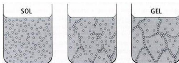
Figura 1.12. Esquema sintetizado del proceso sol-gel.
