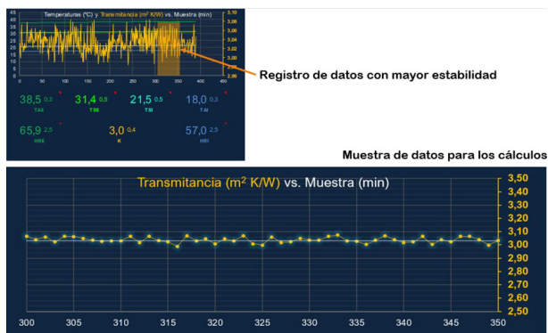
Figura 6. Monitor de datos: Visualización a tiempo real del valor de la transmitancia térmica total ( K_t ) en el intervalo de mayor estabilidad de los valores.
