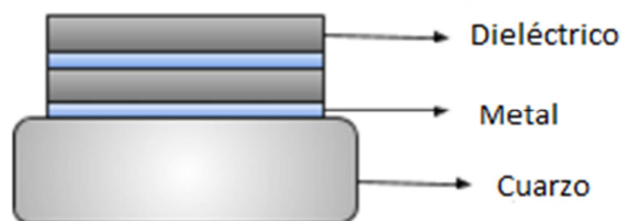
Figura 1: Estructura de los filtros diseñados.
