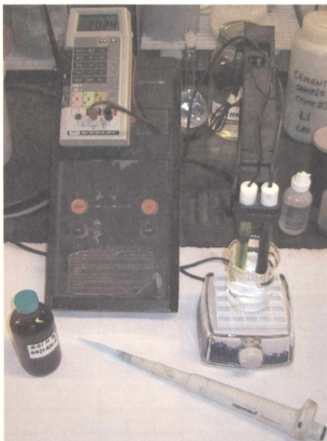
Figura A.I.1: Fotografía del dispositivo empleado en la determinación potenciométrica de cloruro.
