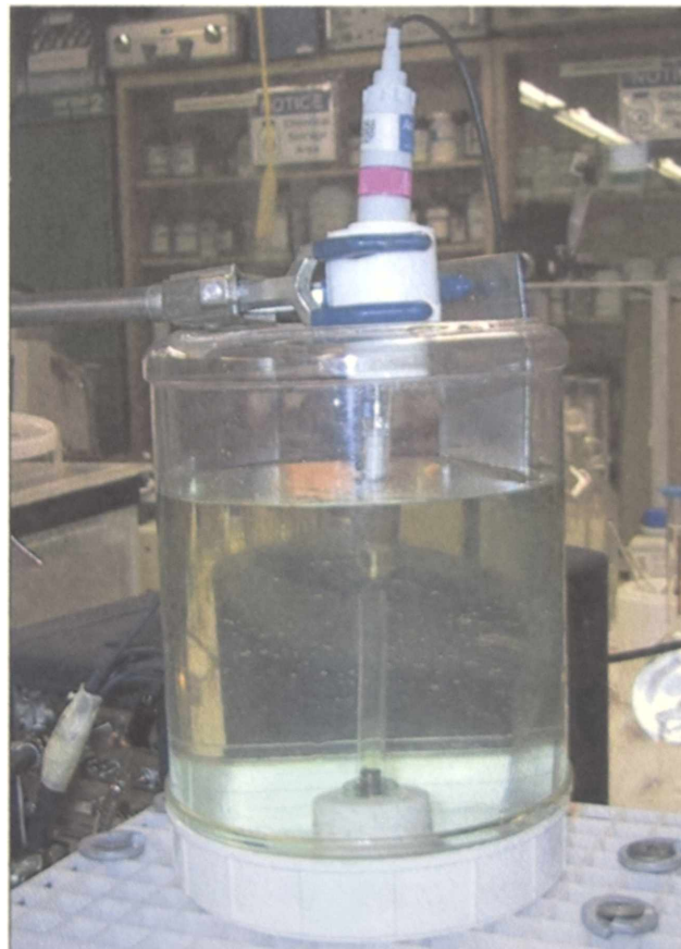
Figura 2.2: Fotografía de la celda electroquímica empleada para las experiencias de simulación de un pit.
