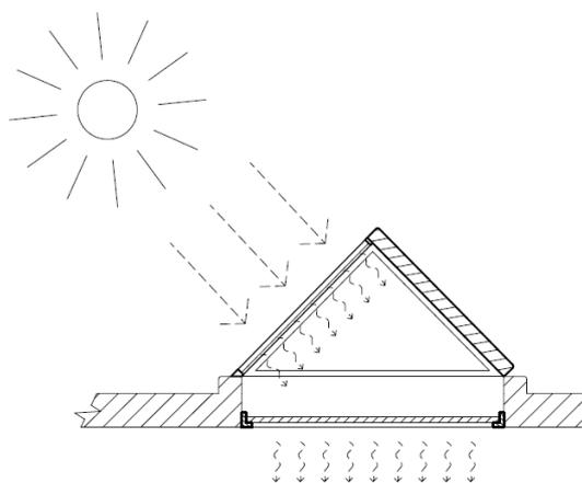
Figura 2: Esquema y fotografías del SIRASOL
