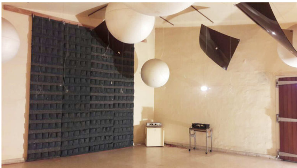
Figura 7: Montaje del sistema modular de jardín vertical compuesto por 12 paneles en la cámara reverberante normalizada- realizado por personal del LAL-CIC
