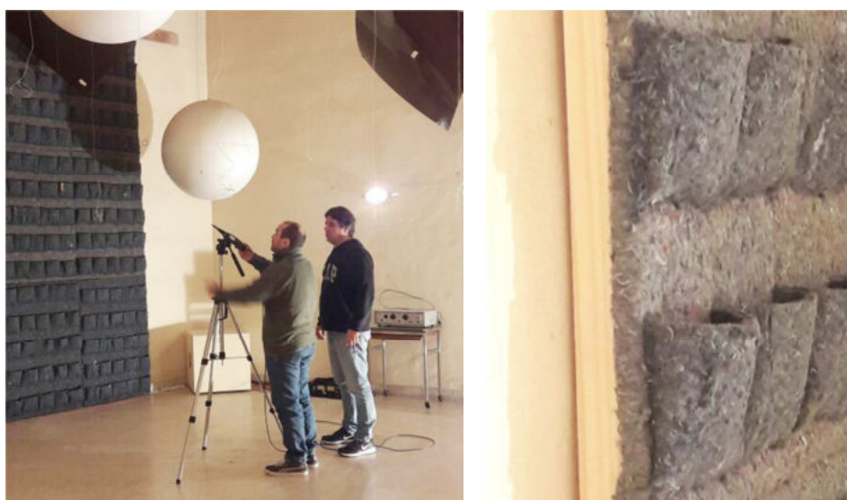
Figura 8: Calibración de equipos y detalle constructivo lateral del montaje realizado por personal del LAL-CIC
