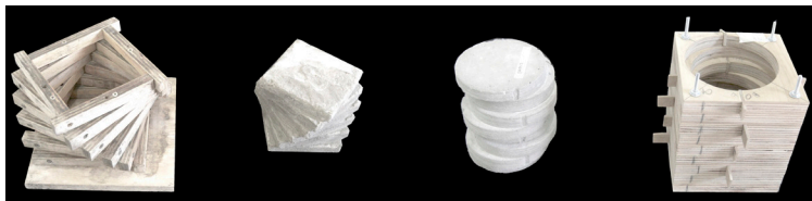
figura 36. moldes en madera y construcción de un piedra de hormigón de 4 kilogramos.
