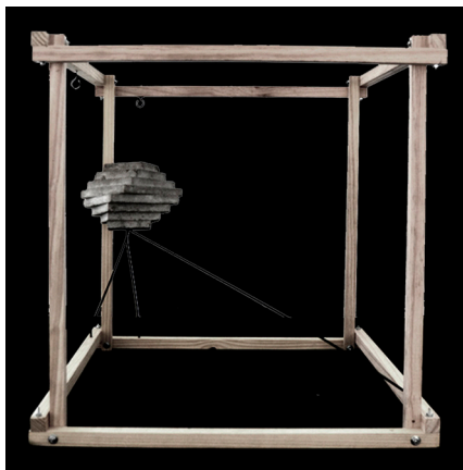
figura 37. bastidores cúbicos de 70 cm de lado para suspender piedra a tracción (tensores) o a compresión (puntales) para realizar ensayo de solicitaciones en equilibrio.
