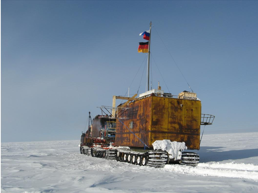
**Figura 3.6.** Medición del perfil S53 durante la campaña 2007/2008. La jaula a la derecha del trailer es la antena de transmisión, la de la izquierda la antena de recepción. En la punta del palo de madera encima del trailer se encuentra la antena GPS de navegación. A la izquierda encima de la cabina del chofer del tractor, se puede apreciar la antena GNSS del relevamiento cinemático.
