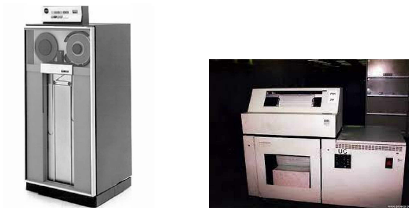
Figura 4. Unidades de cintas magnéticas IBM PH3420A (izq.), impresora IBM 3287 (der.)
