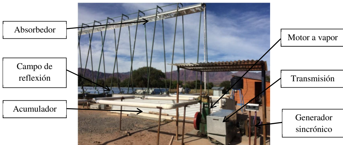
Figura 2: partes del sistema Fresnel Lineal.
