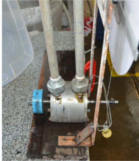
Figura 2. Doble entrada en el estator de la turbina de Tesla.
