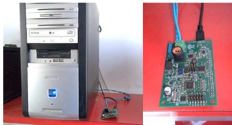
Figura 9: Fotos del server y de la placa PLC
