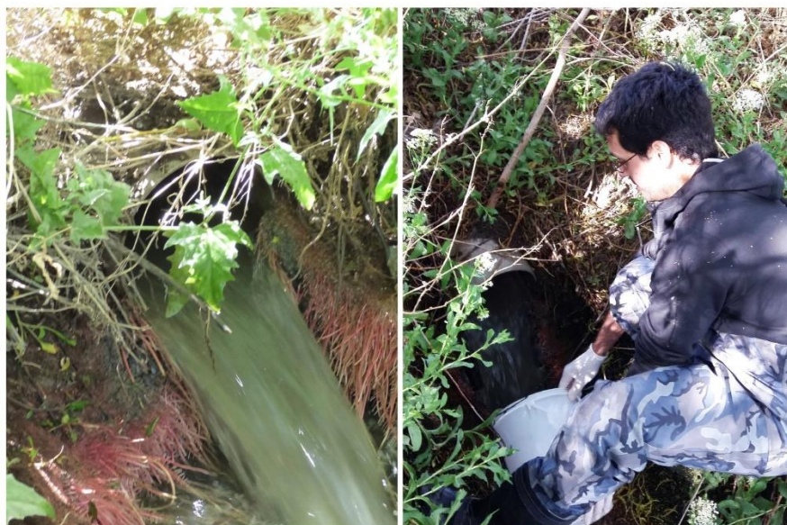
Figura 4. 7. Toma de muestra de efluentes cloacales para el bioensayo de toxicidad total del efluente de la planta de tratamientos de residuos cloacales de la localidad de Gobernador Gregores, Santa Cruz. (Fotografías: Juan Pablo Martin).
