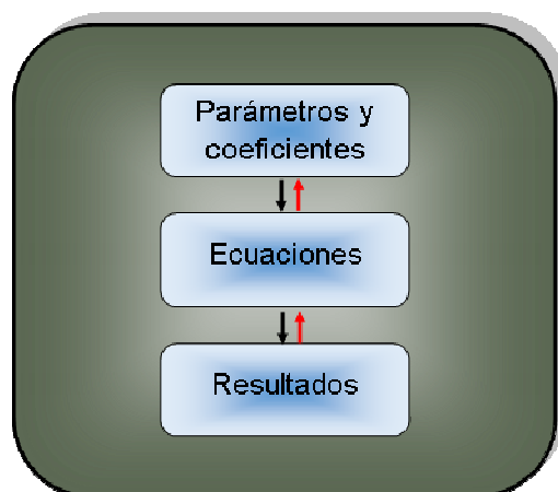
Figura 1: Etapas de la resolución directa (líneas negras) e inversa (líneas rojas) del problema asociado a la caracterización térmica de un edificio.
