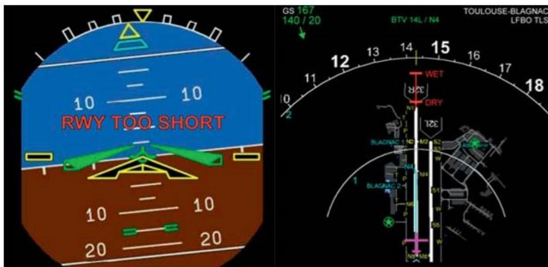
Figura 113. Visualización del PFD y ND en caso de un aviso del ROW por pista seca.
