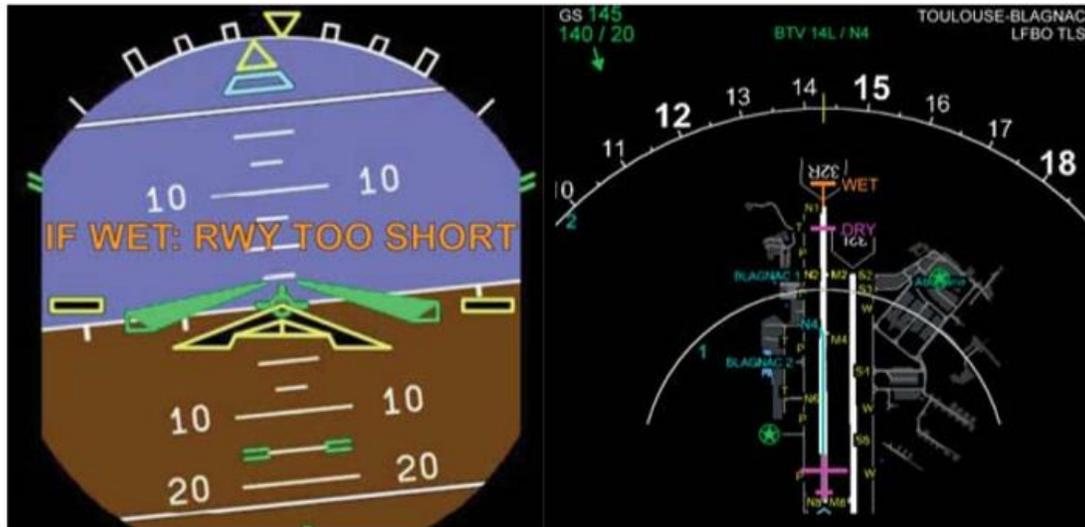
Figura 112. Visualización del PFD y ND en caso de un aviso del ROW por pista mojada.
