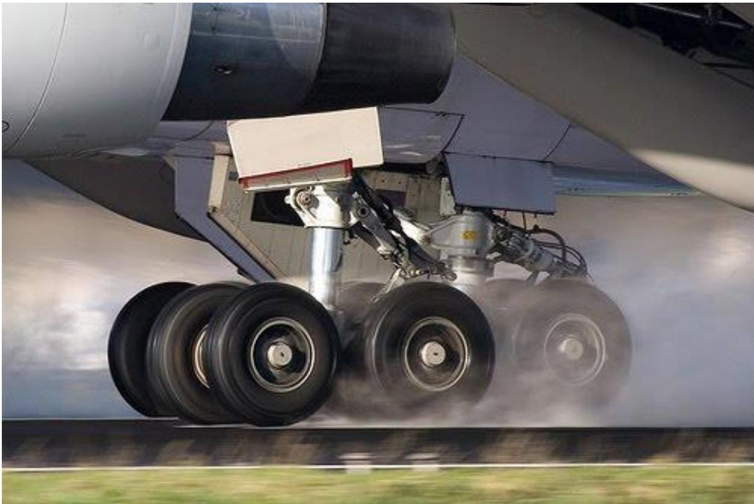
*Figura 72. Tren de Aterrizaje principal de un Boeing B747-400.*
