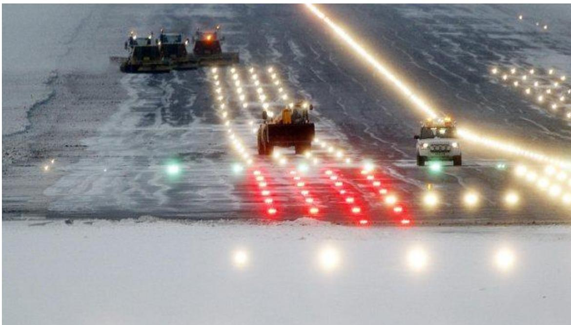
*Figura 14. Limpieza y medición del coeficiente de fricción en una de las pistas del Aeropuerto de Gatwick en Londres, Reino Unido.*
