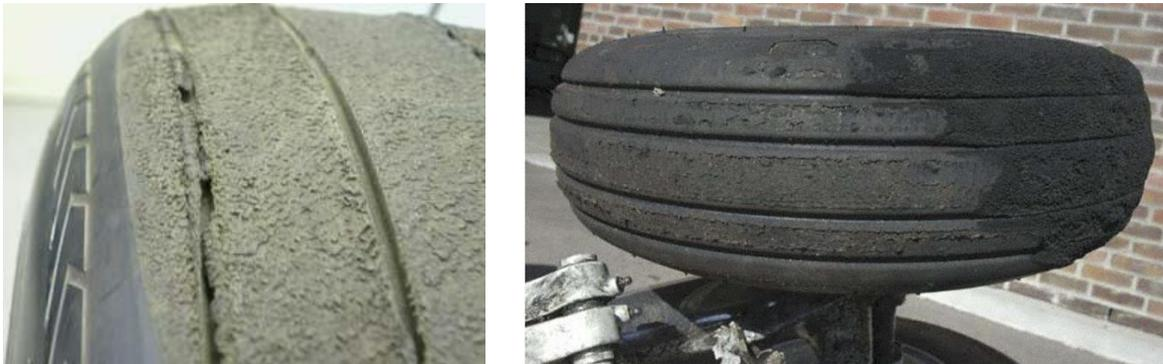
*Figura 71. Ejemplos de Hidroplaneo por Revenido de Caucho.*
