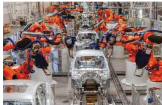
En la fotografía se observan brazos robots haciendo diversas tareas en una línea de montaje de la industria del automóvil (lo que antes lo hacían los humanos). En este caso soldando.
