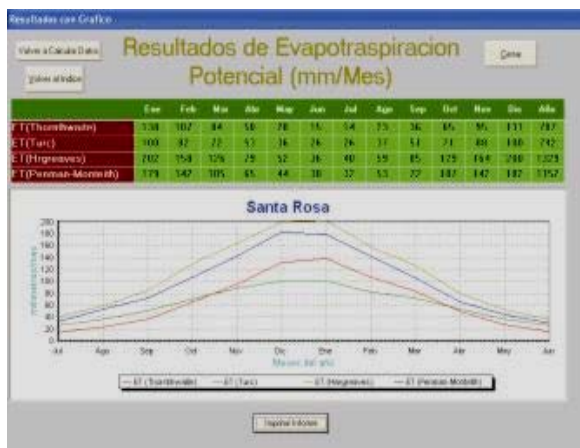
Figura 4: Cálculo de la Evapotranspiración Potencial Para Santa Rosa por diferentes métodos de cálculo.
