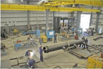
Todos nuestros trabajos son respaldados por una sólida estructura propia, tanto de recursos humanos como de instalaciones y equipos. Dentro de la misma contamos con dos talleres centrales donde se realizan construcciones metálicas, equipos paquetizados y estructuras de piping. Estos están dotados de equipos, almacenes de materiales y herramientas adecuados para un desarrollo eficiente.
