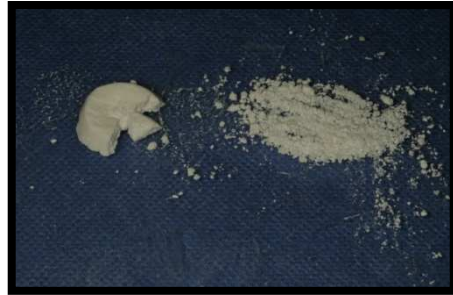
Figura 10: Bloque del material luego del fraguado, e inicio de la fragmentación.
