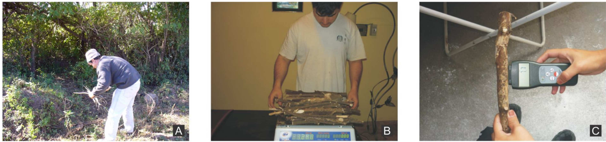
Figura 4. A) recolectando muestras de leña. B) pesando leña. C) medición de la humedad.
