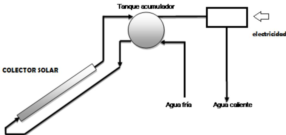
Figura 1. Esquema de la instalación combinada calentamiento de agua.
