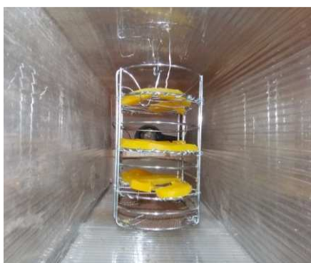
Figura 1: Interior del secador con muestra de frutas frescas.
