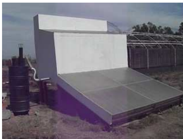
Figura 3: Cámara de secado con colector solar, y sistema auxiliar.
