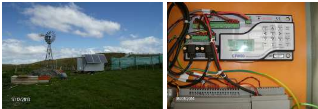
Figura 3 – Refugio con paneles instalados (izq), y sistema de control y registro con CR850
