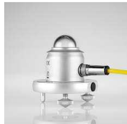
Figura 2: Piranómetro CM3 de Kipp & Zonen para la medida de la radiación solar global.
