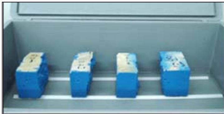
Figura 3.3.3.4. Ensayo de absorción capilar.
