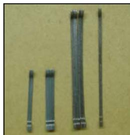
Figura 5.2.1. Fibras de acero tipo *hooked-end* (30 y 60 mm).
