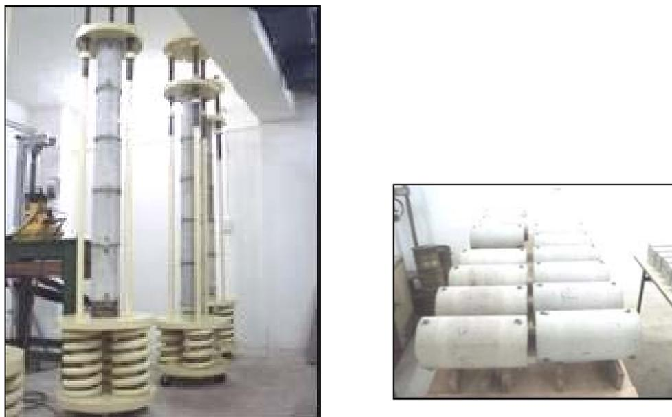
Figura 3.3.3.13. Pórticos con resortes y detalle de las probetas con los pernos de acero inoxidable, en la foto se muestran los ensayos para el estudio del inciso 4.4.
