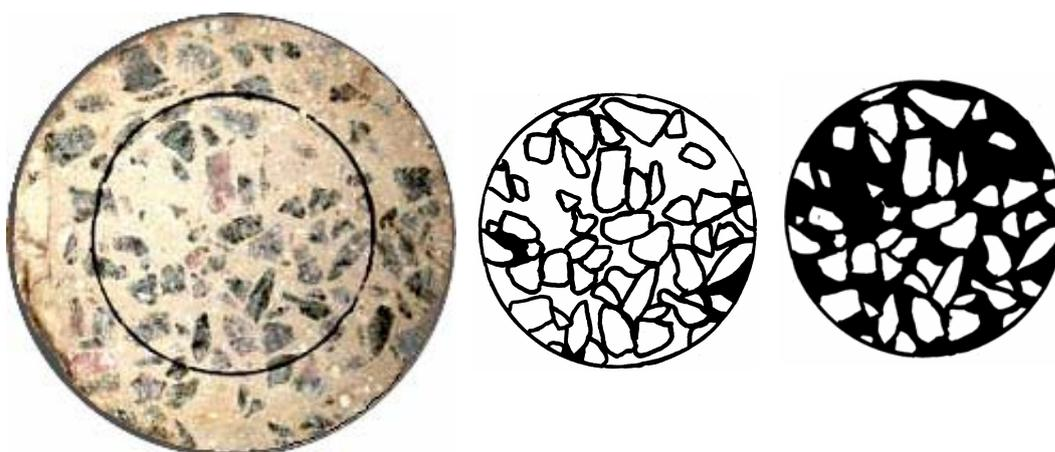
Figura 3.3.1.1. Sección de hormigón, imagen escaneada y posterior acondicionamiento.
