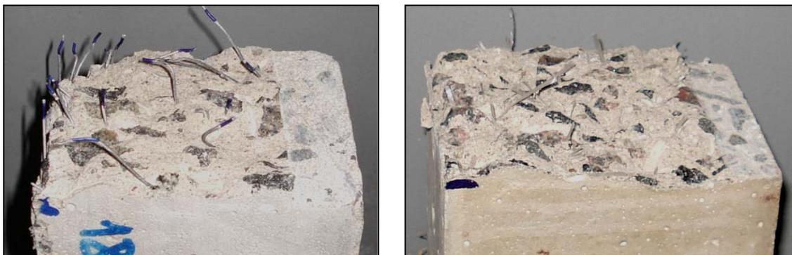
Figura 3.3.2.1. Superficies fracturadas de vigas entalladas ensayadas a flexión.
