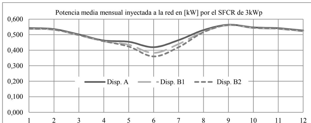
Fig. 5: Potencia media mensual generada por la instalación de referencia de 3kWp, calculados en base a los valores de energía.
