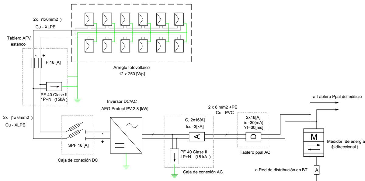
Fig. 1: Ejemplo de esquema general de la instalación.
