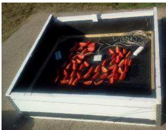
Figura 5: Secador con tomates, termocuplas e indicadores de humedad (sin la tapa)
