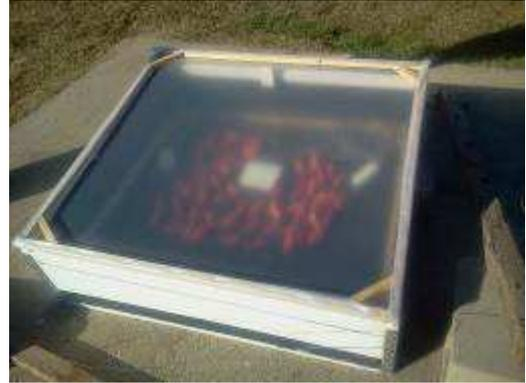
Figura 17: Prototipo de secador solar terminado.
