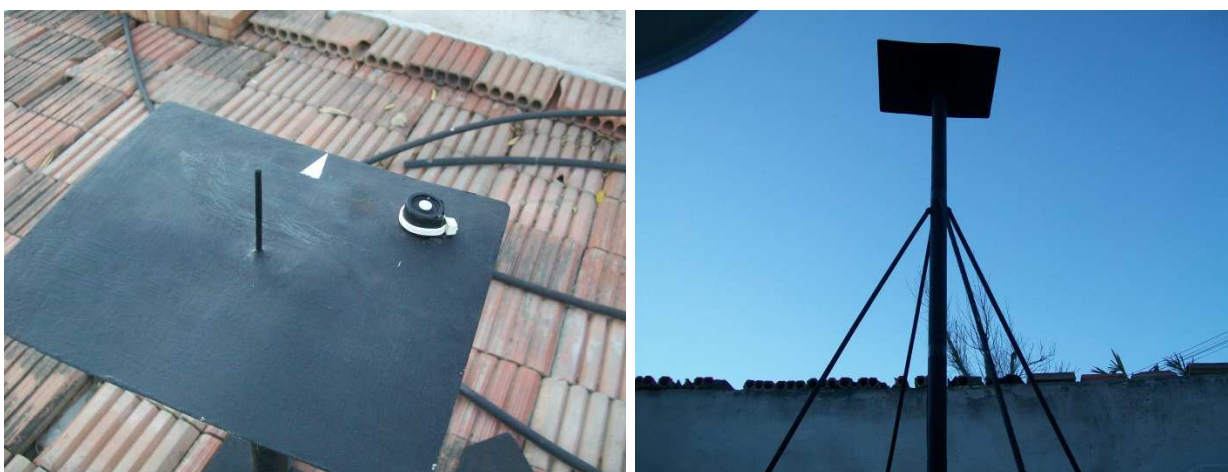
Fig.1. Vista del sensor de radiación solar LI-200 instalado en Catamarca
