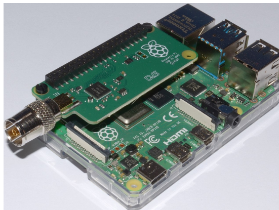
Figura 5: Una SBC Raspberry PI 4 Modelo B con una tarjeta de expansión para recibir la señal de TV modulada en DVB-T/T2.
