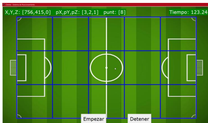
Fig. 5. Interfaz gráfica de seguimiento de la ubicación de la pelota en la cancha de fútbol.
