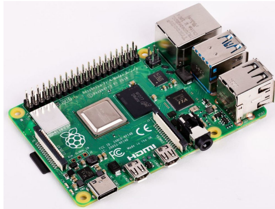
Figura 2: Una computadora de placa única de la marca Raspberry Pi 4.
