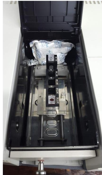
**Figura 3.4:** Posición de las celdas de muestra y blanco.
