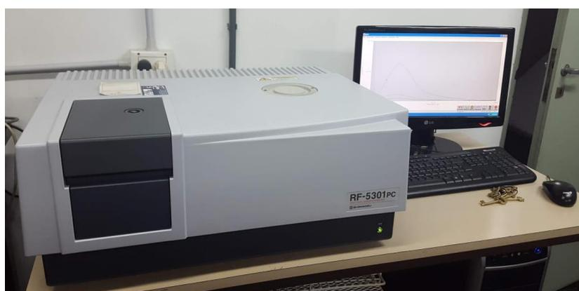
**Figura 3.6:** Espectrofluorómetro RF-5301PC Shimadzu utilizado.
