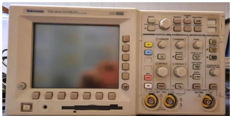
**Figura 3.11:** Osciloscopio Tektronix TDS 3032.
