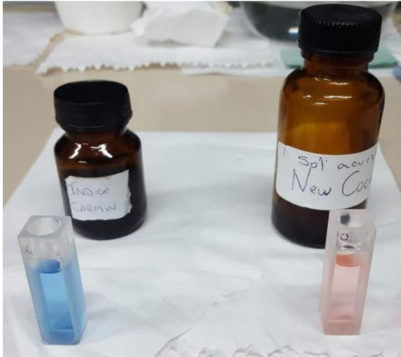
**Figura 3.1:** New Coccine e Índigo Carmín en cubetas de cuarzo previo a realizar la medida espectrofotométrica.
