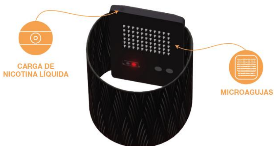
Figura 3. Elementos inferiores del dispositivo
