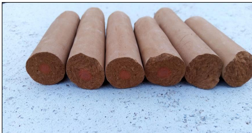
Figura 28. Detalle del corazón rojo de la muestra 1 a 900°C. Fuente propia
