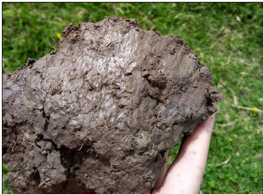
Figura 13. Detalle de Slickensides muestra 4. Fuente propia.
