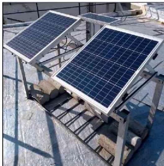
Figura 2: Equipo medidor de suciedad
