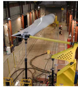
Figura 5 - Banco de prueba de fatiga
