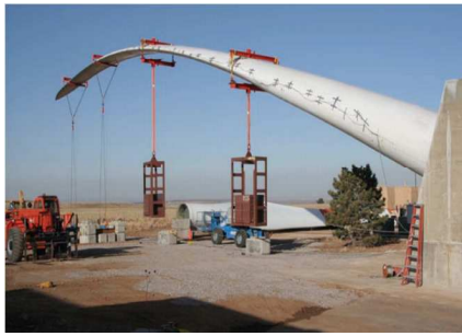
Figura 4 - Prueba de resistencia mecánica
