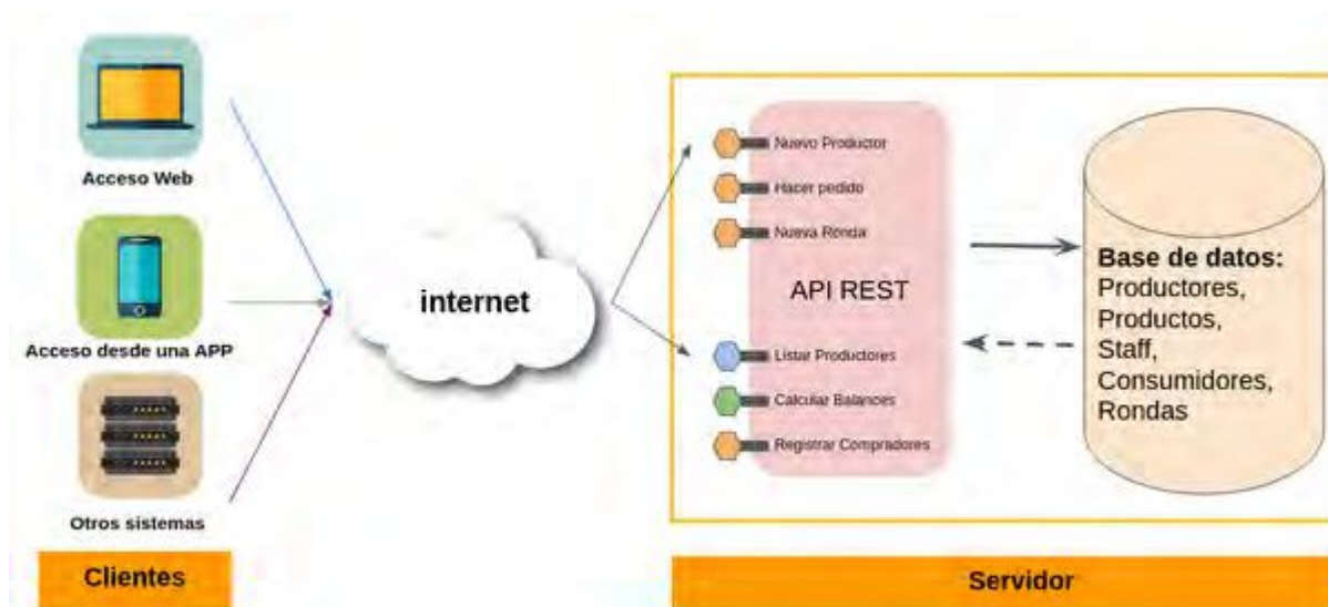
Figura 9: Diagrama de arquitecturas Cliente Servidor
