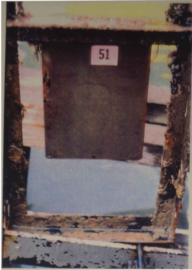
a) Colofonia WW Espesor de película seca requerida, mínimo 300 \mu\text{m} Eficiencia, 100 %
