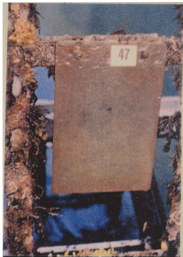
d) Resinato de calcio desproporcionado Espesor de película seca requerida, mínimo 200 \mu\text{m} Eficiencia, 100 %
