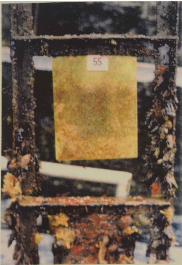
c) Resinato de calcio Espesor de película seca requerida, mínimo 200 \mu\text{m} Eficiencia, 90 %
