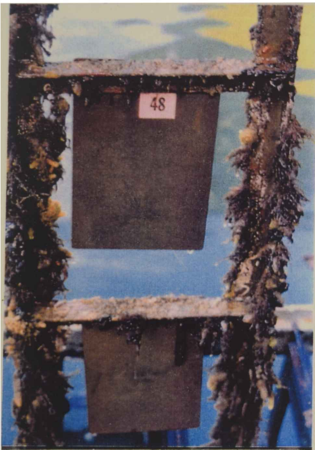
c) Resinato de calcio Espesor de película seca requerida, mínimo 300 \mu\text{m} Eficiencia, 100 %
