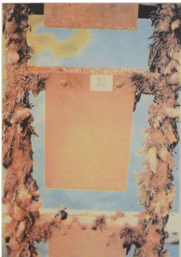
Fig. 5.4. Pintura basada en resina colofonia original (relación 2/1), 24 horas de exposición al aire antes de la inmersión, 36 meses de ensayo.
