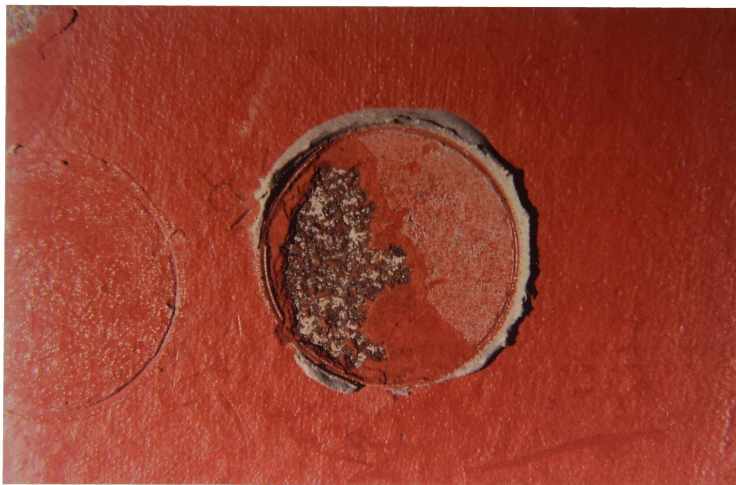
11.5. Falla adhesiva/cohesiva en la película (Elcometer); PVC 40 % pigmento inhibidor, tanato de cromo; grado de oxidación
