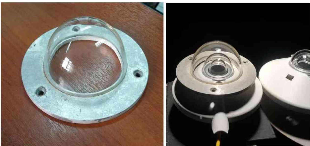
Figura 4: Izquierda: cúpula adicional colocada sobre el CMP11 para verificar efectos térmicos debido al rociado de gotas Derecha: cúpula adicional colocada sobre el radiómetro
