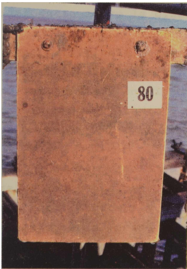
Fig. 57.- Panel correspondiente a la pintura 2 (elaborada con el copolímero A), fijación 0 (100 % de eficiencia) luego de 25 meses.
