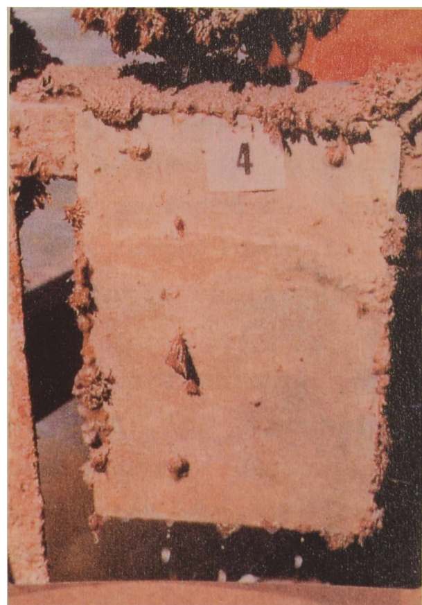
Fig. 58.- Panel correspondiente a la pintura 6 (elaborada con el copolímero D), fijación 1 (80 % de eficiencia) luego de 25 meses.
