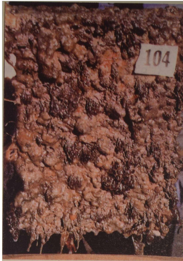
Fig. 56.- Aspecto que presenta el panel testigo (sin protección antiincrustante) luego de 25 meses de inmersión.
