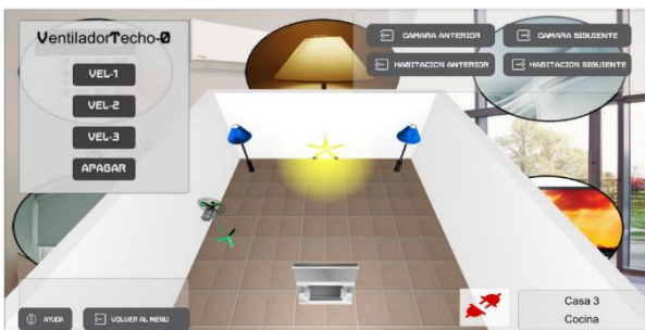
Figura 4. Aplicación móvil 3D de domótica. Control visual de los dispositivos.
