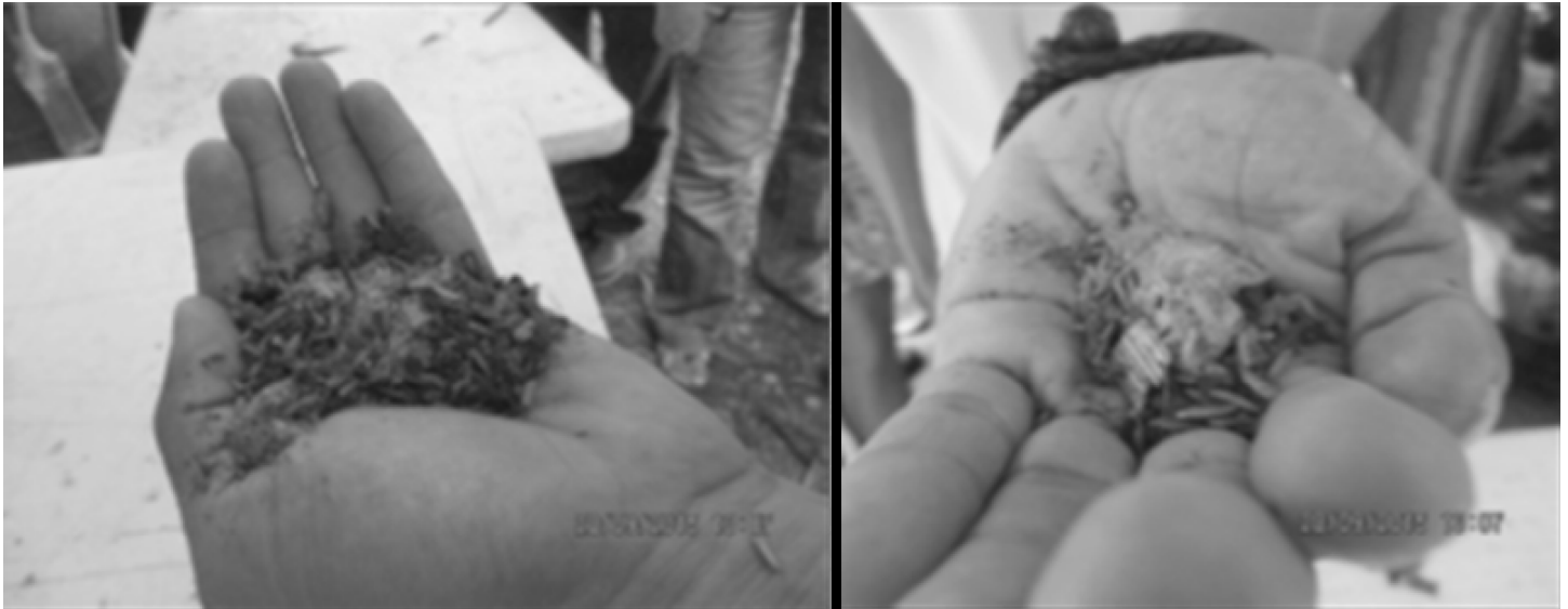
Fig. 3. Restos de mantillo o broza con suelo con burbujeo ante el agua oxigenada.
