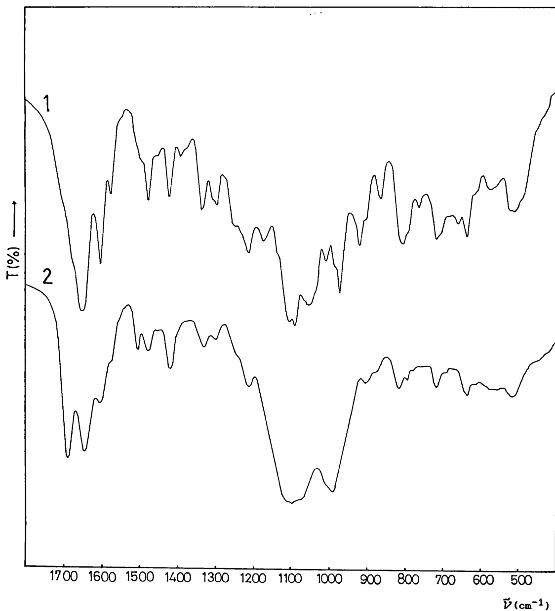
Figura 35. Espectros de IR de (1) AMP y (2) VO/AMP/Bz en KBr.
