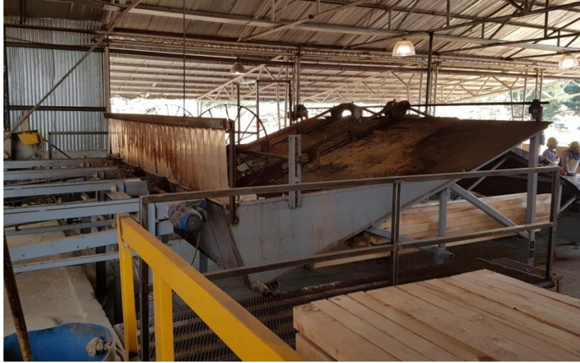
Figura 3.36. Vista general de la batea de baño antimancha (Abra Ancha, Neuquén). Fuente propia (viaje de estudios Ing. Ftal., 2018).
