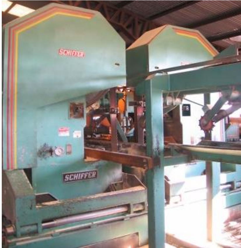
Figura 3.9. Sierra sinfín vertical doble (Corrientes). Fuente: propia (viaje de estudios Ing. Ftal, 2007).
