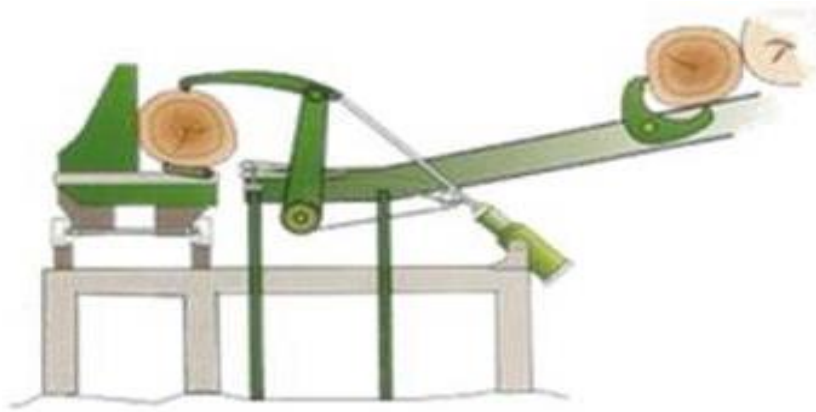
Figura 3.21. Cargador de trozas. Fuente: García Esteban et al. (2002).
