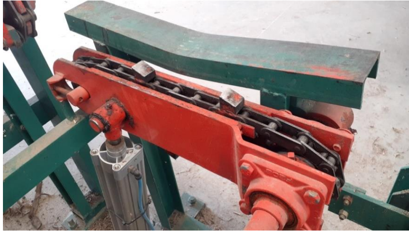
Figura 3.23. Volteador de cadena-CTM. Fuente: propia (2020).
