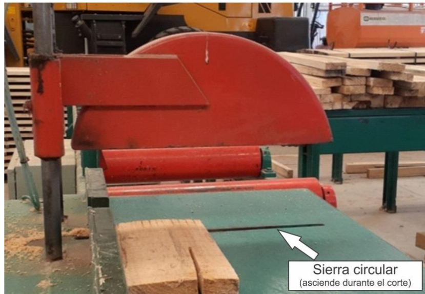
Figura 3.11. Sierra circular simple de eje móvil vertical (función despuntadora)-CTM. Fuente: propia (2019).
