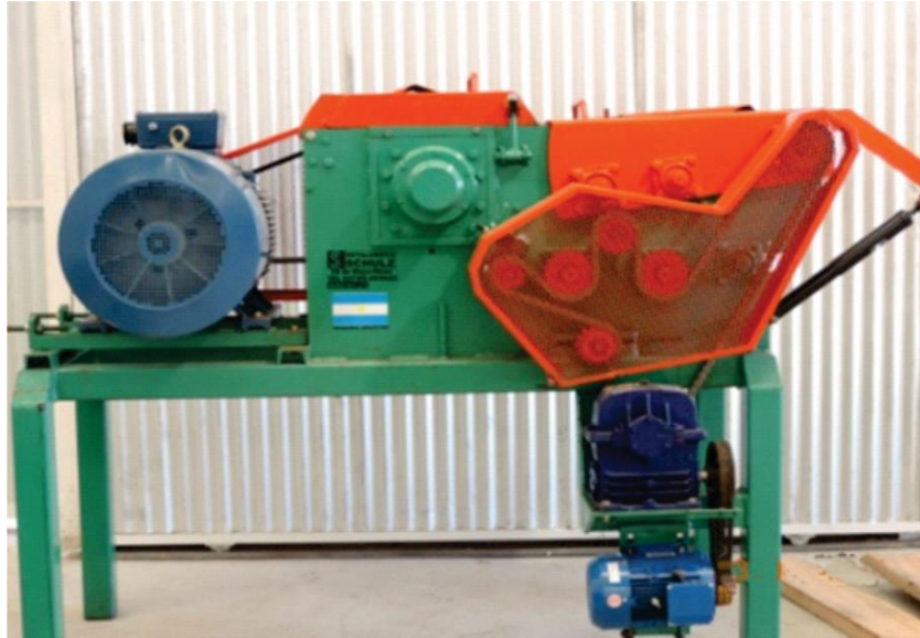
Figura 3.33. Astillador de tambor del aserradero-CTM. Fuente propia (2017).
