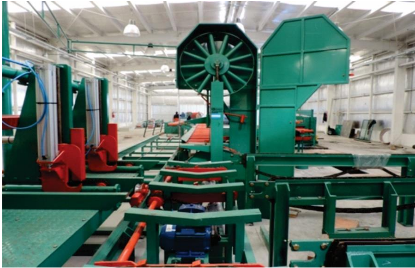
Figura 3.5. Protector de cinta abierto de sierra sinfín vertical simple-CTM. Fuente: propia (2017).
