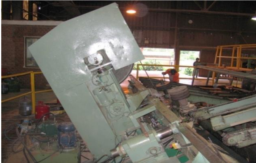
Figura 3.10. Sierra sinfín inclinada simple (Virasoro, Corrientes). Fuente: propia (viaje de estudios Ing. Ftal., 2007).
