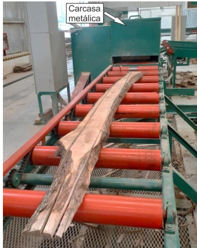
Figura 3.13. Sierra circular doble de un eje con carcasa protectora (función canteadora)-CTM. Fuente: propia (2021).
