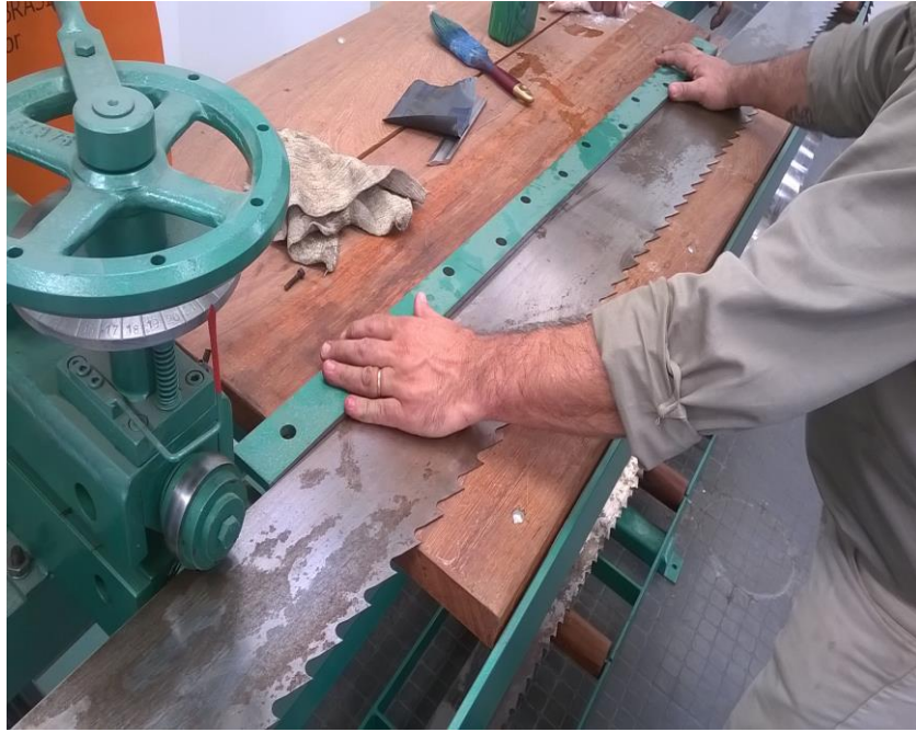
Figura 4.29. Control de rectitud de la hoja-CTM. Fuente: propia (2019).
