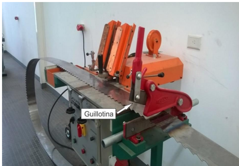
Figura 4.23. Guillotina-CTM. Fuente: propia (2019).
