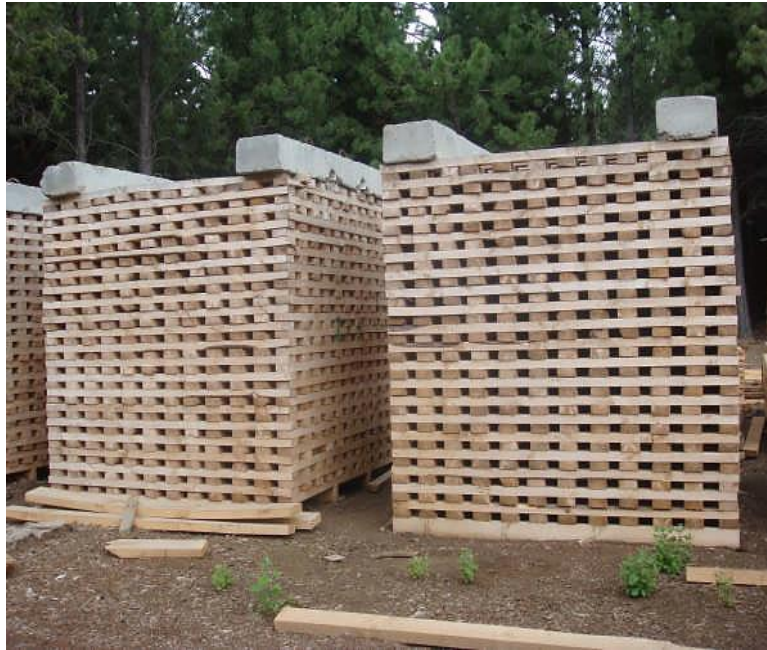
Figura 5.7. Secado natural a la intemperie (Abra Ancha, Neuquén). Fuente: propia (viaje de estudio Ing. Ftal., 2006).
