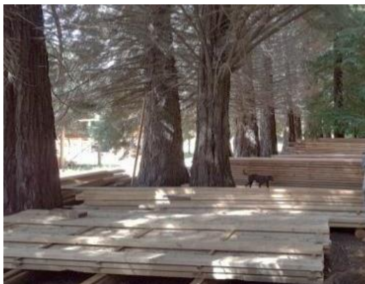
Figura 5.8. Secado natural bajo dosel (Quechuquina, Neuquén). Fuente: propia (viaje de estudio Ing. Ftal., 2018).
