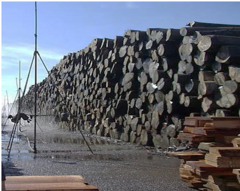
Figura 2.9. Protección de trozas por aspersión de Eucalyptus grandis (Virasoro, Corrientes). Fuente: propia (viaje de estudio Ing. Ftal., 2003).
