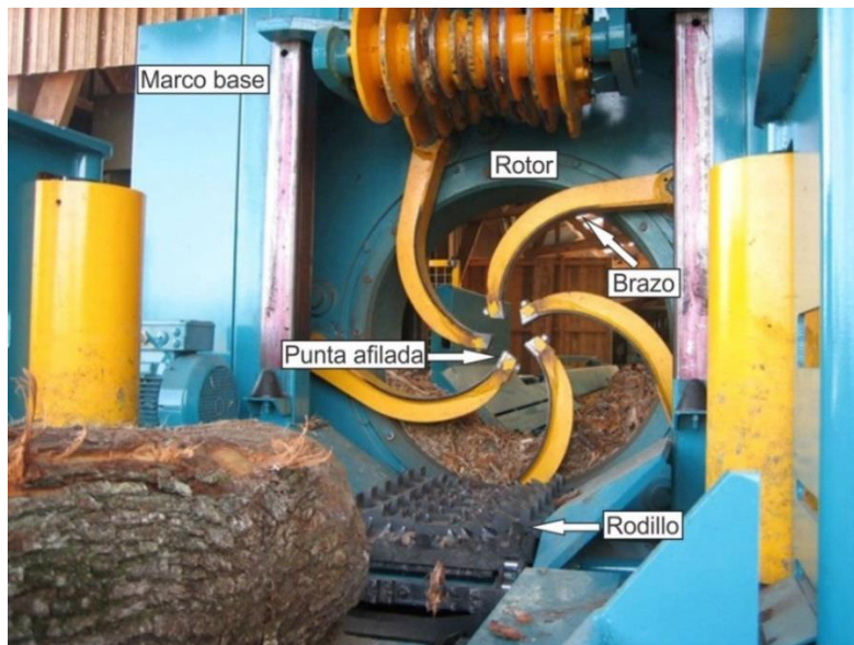
Figura 2.13. Descortezador de anillo mecánico. Fuente: Direct Industry (2020) 12 .
