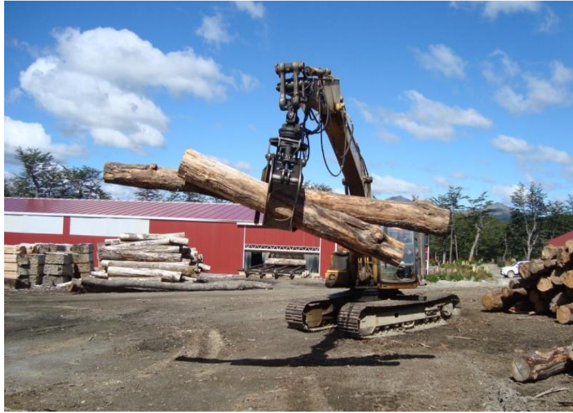
Figura 2.11. Cargador de trozas con oruga de Nothofagus pumilio (Tolhuin, Tierra del Fuego). Fuente: propia (viaje de estudio Ing. Ftal., 2017).
