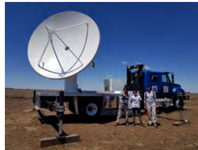
(b) COW: Radar de Banda C sobre rueda. Imagen extraída de la página https://www.facebook.com/CSWRDOW/
